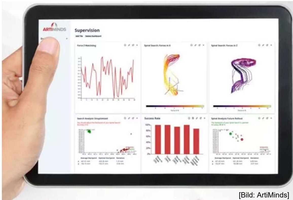
ArtiMinds LAR (Learning & Analytics for Robots) unterstützt den Zugriff auf Sensordaten sowie die 2D/ 3D-Aufbereitung dieser Daten in einem Dashboard.
