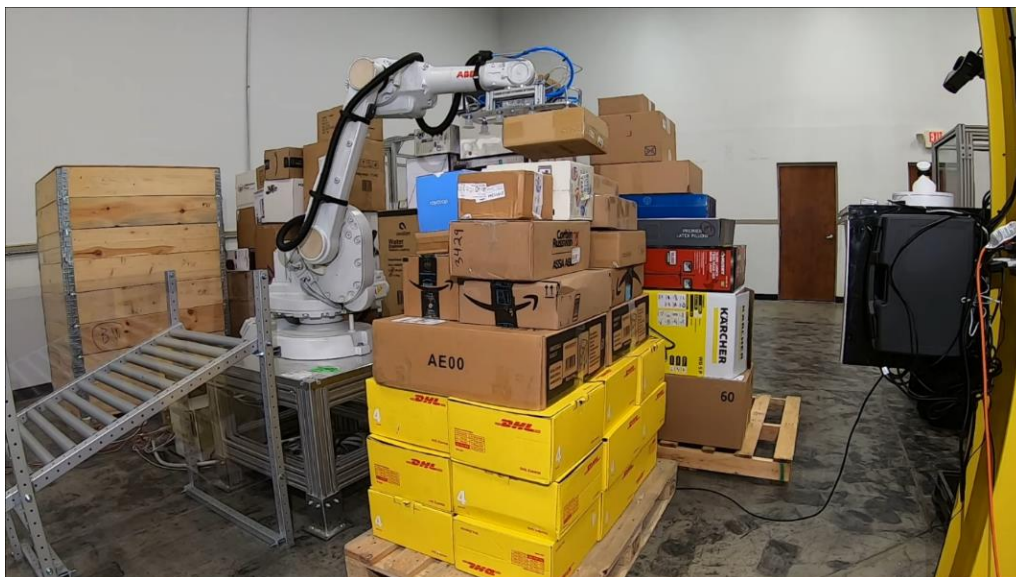
Abbildung 19: Depalettierung mit einem ABB Roboter und einem Photoneo 3D-Vision-System mit maschinellem Lernen [38]
