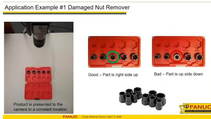
Abbildung 20: Überprüfung, ob Muttern vorhanden und korrekt positioniert sind [42]
